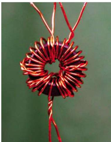
**Bild 7: Die bifilare Sekundärwicklung verteilt sich ebenfalls gleichmäßig**
