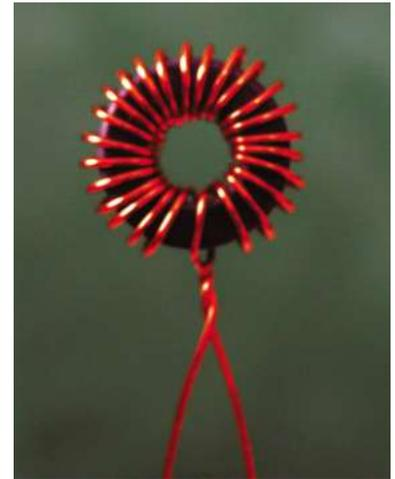
**Bild 6:** Die Primärwicklung ist auf dem Kern gleichmäßig zu verteilen
